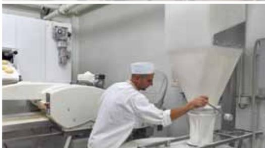
Trémies de dosage et façonneuses
