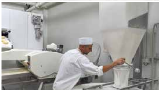
Trémies de dosage et façonneuses
